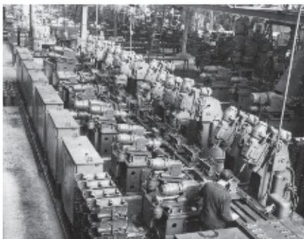
Atelier d'usinage des moteurs : machines transfert conçues par Pierre Bézier.
